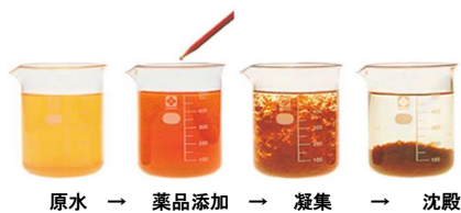
薬品で「きれいな水」に処理する設備
