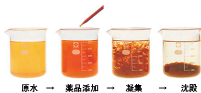
薬品で「きれいな水」に処理する設備
