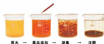
薬品で「きれいな水」に処理する設備
