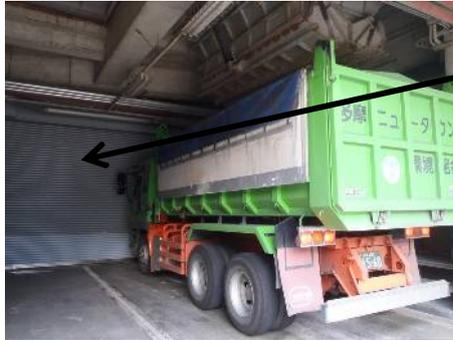
外に飛散しないように、積み込時はシャッターを閉めます。
